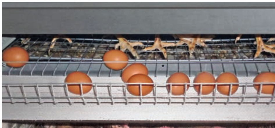
EggSaver опущен → мягкое притормаживание яйца
