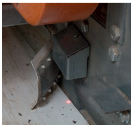
Световой датчик для мониторинга ровного хода ленты ПУ
